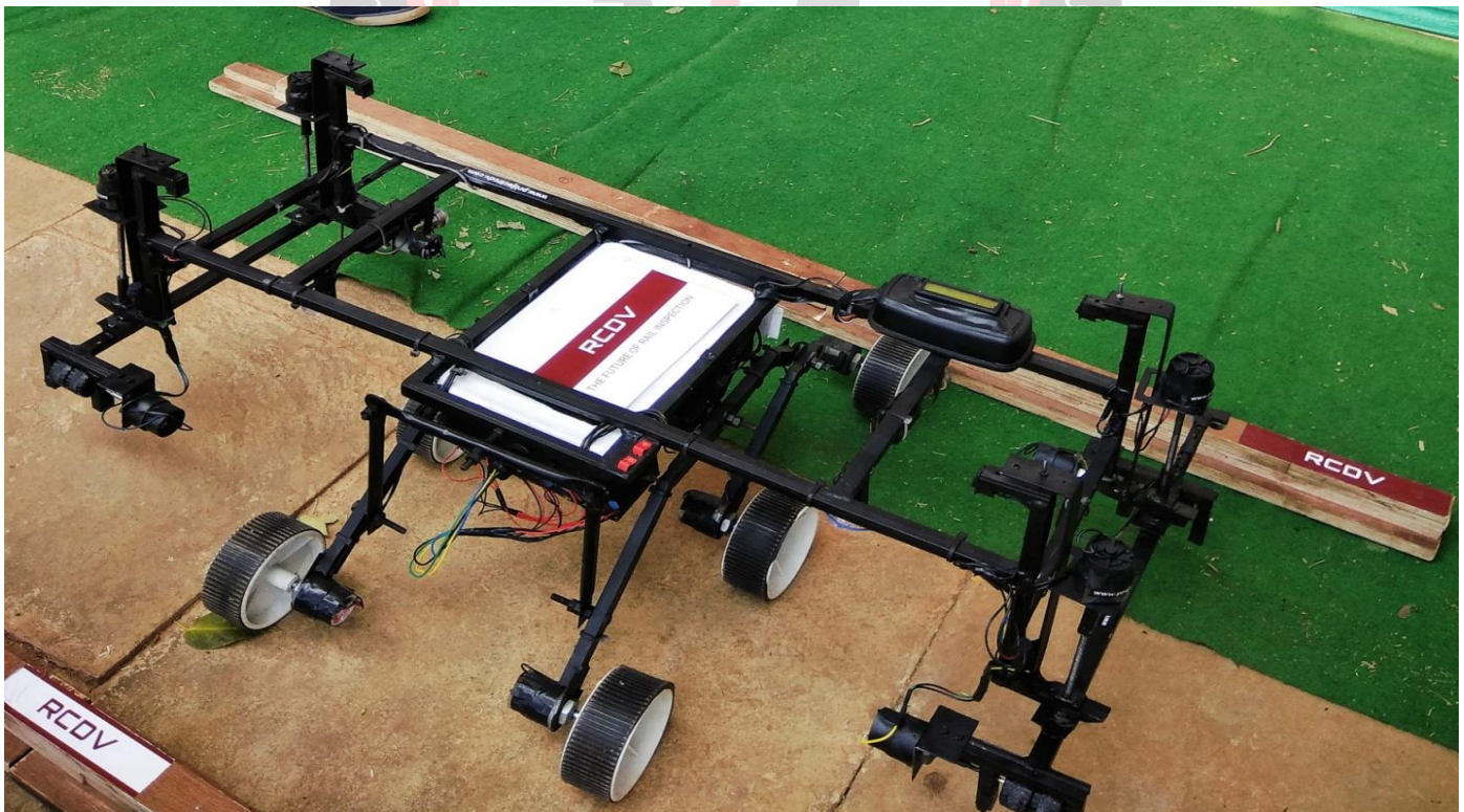
Fig. d) Actual model of Rocker Bogie mechanism
