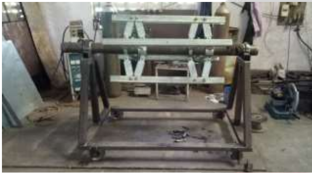
Fig.3. Actual Decoiler Mechanism
