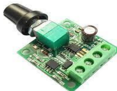
Fig.16. DC Motor Controller
