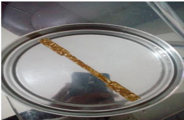
Fig. 6 Moisture Absorption Test
